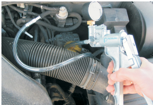
Проверка клапана EPW с использованием ручного вакуумного насоса (автомобиль VW Golf IV) (Pierburg Товарный номер изделия 12 00001 11 900)
